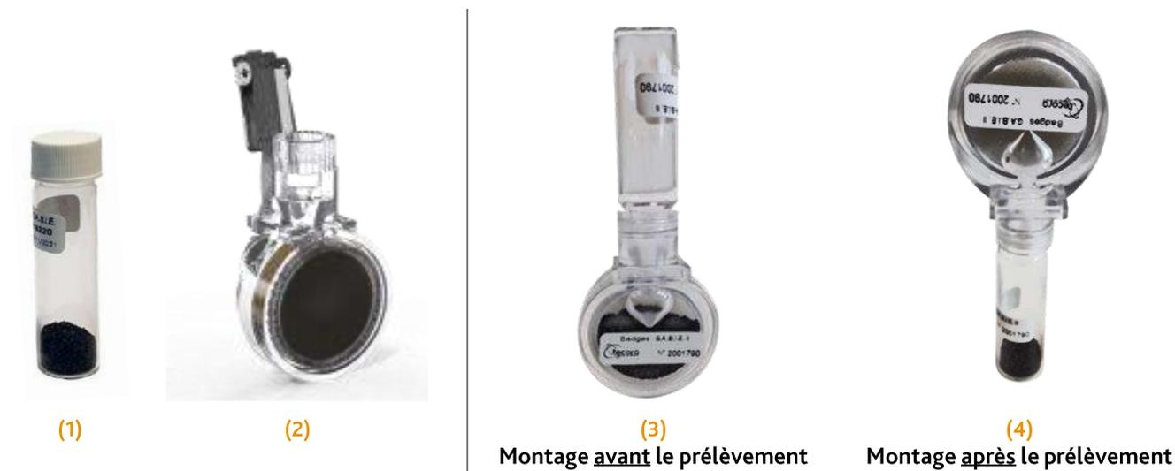
Les éléments constituant les badges G.A.B.I.E. (flacon + corps rond) sont réceptionnés au laboratoire dans leur sachet en plastique d'origine et sont **conservés à température ambiante et à l'abri de la lumière**. Ils sont ensuite placés dans une pochette en aluminium avec fermeture zip pour l'envoi au client.
