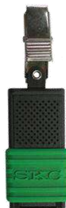
Badge en position ouverte (prélèvement en cours)
